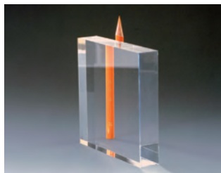
厚いガラスのむこうの鉛筆がずれて見えている。
