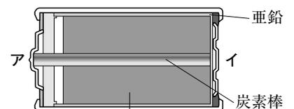
二酸化マンガンと黒鉛の粉末とを塩化亜鉛の水溶液で練り合わせたもの
